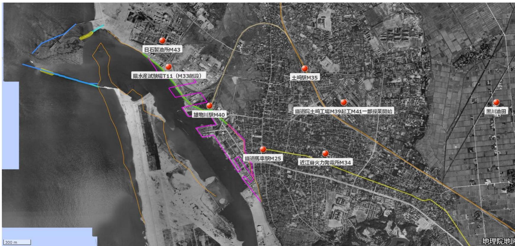
図 11 土崎港修築工事による延長突堤・防波堤（黄色線）
