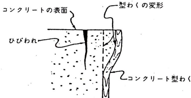
型わくの変形によるひびわれ
