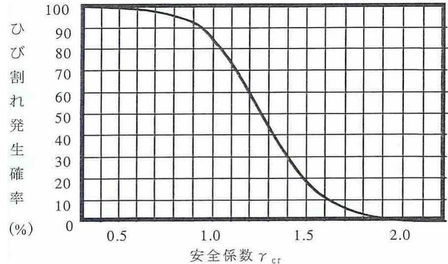
解説 図 4. 2. 1 安全係数  $\gamma_{cr}$  とひび割れ発生確率
