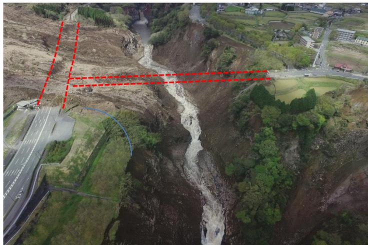
国道57号を塞ぎ阿蘇大橋を落橋させた大規模山腹崩壊
