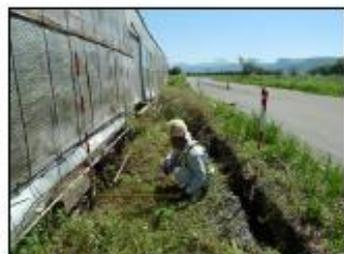
⑥ 開口亀裂 W=14cm(ハウス側)、W=20cm(道側)
