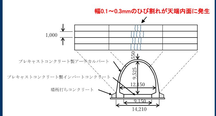
ひび割れは、アーチカルバートの天端軸方向に、図に示すような 箇所に多く発生していた。円周方向には数本のひび割れが約 250mmの等間隔で発生していた。ひび割れの幅は0.1~0.3mmで平 均0.14mmであった。また、ひび割れの深さを超音波測定器にて測 定したところ40~110mmであり、部材を貫通していないことが確認で きた。内側の鉄筋かぶりを電磁誘導法によって測定したところ、設 計値の43mmに対して若干大きい48~68mmであった。コンクリート の圧縮強度はテストハンマー(シュミットハンマー)を用いた反発硬 度法で推定したところ52~57N/mm2であり、設計基準強度を満足し ていることが確認できた。
