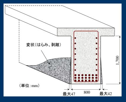
変状が生じた部分においては、<u>表層部コンクリートが型枠のはらみに伴い、下方に流下した様子</u>が伺える。コンクリートが流下しなかった部分では型枠と接していたことから表面に光沢が残っている。
