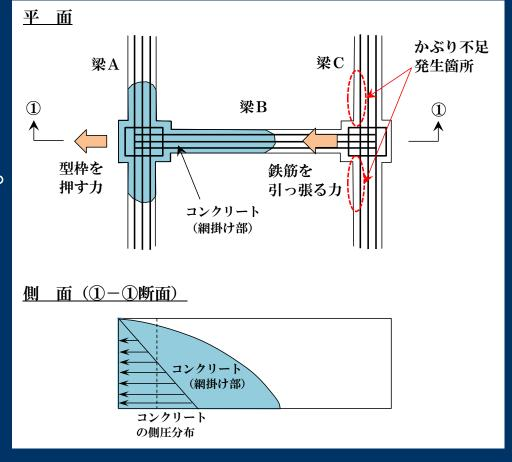
⑥ このとき、梁Cでは鉄筋のかぶりを確保するためのスペーサの 数および取付け方法が不十分だったため、スペーサの移動や 脱落が生じて鉄筋が型枠側(写真の左側)に湾曲して、かぶり不 足箇所が生じた。 上記のように、コンクリートの打込みによって梁の鉄筋が移動して、かぶり不足が生じた原因としては、鉄筋とスペーサが堅固かつ正確に組み立てられていなかったためにスペーサが動くなどして鉄筋と型枠の固定が不十分となったこと、支保工による型枠の支持が無かったこと、コンクリートを局所的に一気に打ち上げ過ぎたために型枠に過度の偏った側圧が作用したこと、などが挙げられる。
