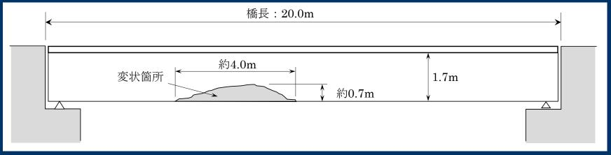
はらみなどの変状が生じた箇所近傍についてテストハンマーによる調査を行ったところ、変状の無い健全な箇所と同程度の強度が得られた。鉄筋探査計により鉄筋位置(かぶり)を測定したが、鉄筋自体の移動は見られず、コンクリートだけがはらみ出したものと判断された。
