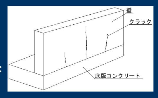
5日後、朝の気温が0℃の寒い日だったが、ブルーシートをはずし、 次に型枠材をはずした。その日は気がつかなかったが、翌朝コンク リートの壁には、鉛直方向に4m程度おきに規則正しく0.4mm前後の クラックが発生していた。
