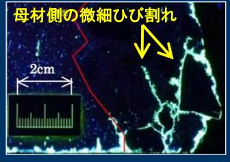
ところ、ひび割れは母材コンクリート側の粗骨材の界面部分が剥離したものであることが判った。他方、吹付けモルタルと母材コンクリートとの付着については、良好な状態であった。 44
