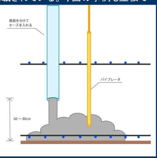
積算上、コンクリートの打設には鉄筋工は計上されていない。ところが<mark>部位によっては、コンクリート打設に鉄筋工が必要</mark>になる場合がある。
